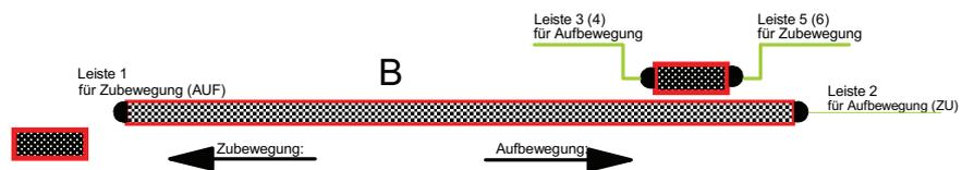
Leiste 1 und 2 in Reihe extern verdrahtet mit 1x Abschlußwiderstand 8K2:
